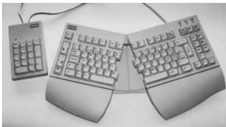
Bild 53, 54 «Ergo-Tastatur» mit einem verstellbaren Winkel und einem getrennten Zahlenblock.
