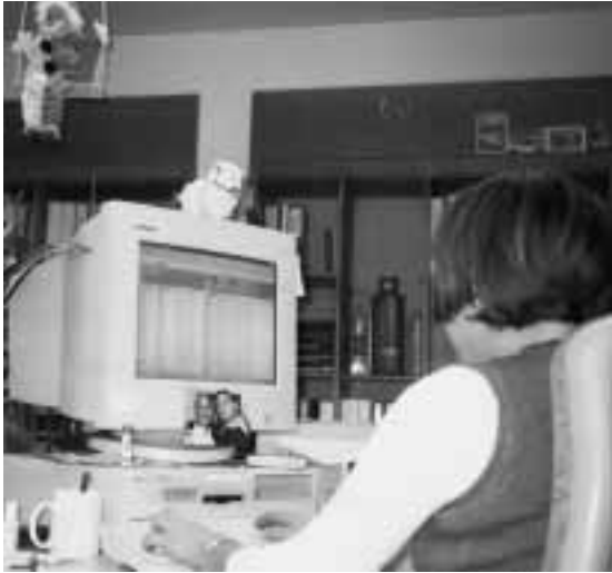
Bild 46 Wird der Bildschirm auf den Rechner gestellt, steht er zu hoch.
