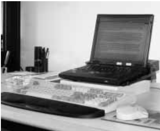
Bild 36 Notebook in einer Dockingstation an einem stationären Arbeitsplatz mit externer Tastatur und Maus.
