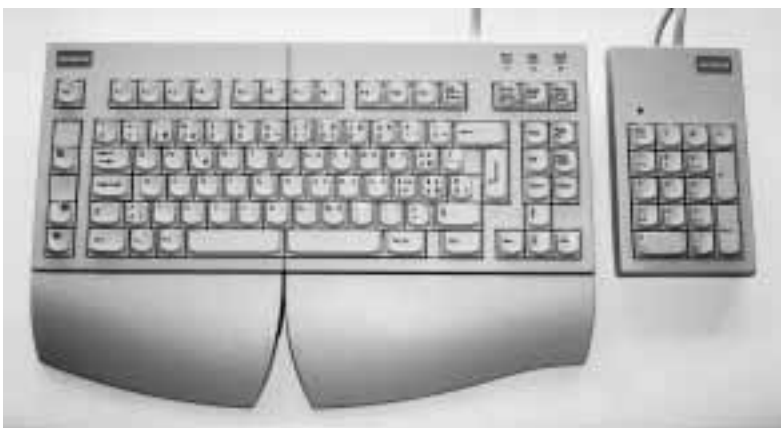
Bild 51 Knickbare Tastatur mit einem getrennten Zahlenblock.
