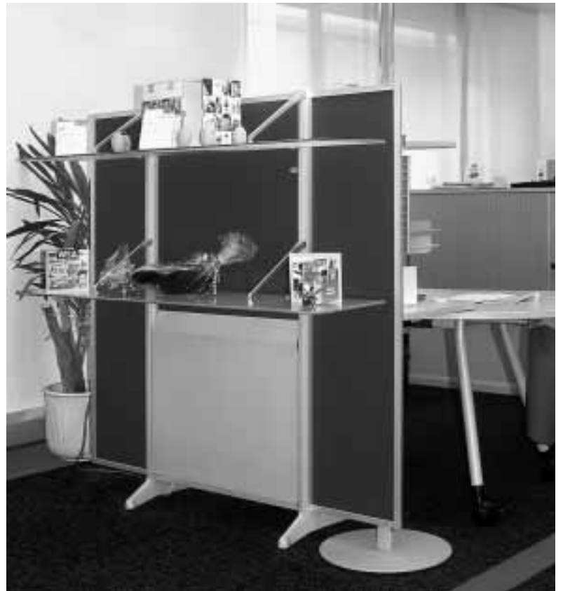
Bild 124 Raumakustische Massnahme in einem Büro: absorbierende Stellwand.
